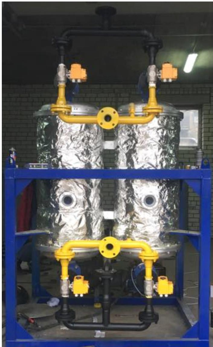
Цикл осушки газа в одном адсорбере длится 8 часов. После происходит переключение газа на второй адсорбер, а первый адсорбер подвергается восстановлению. Примерное полное время восстановления адсорбера около четырёх часов – оставшееся время нефункционирующий адсорбер находится в режиме ожидания.
